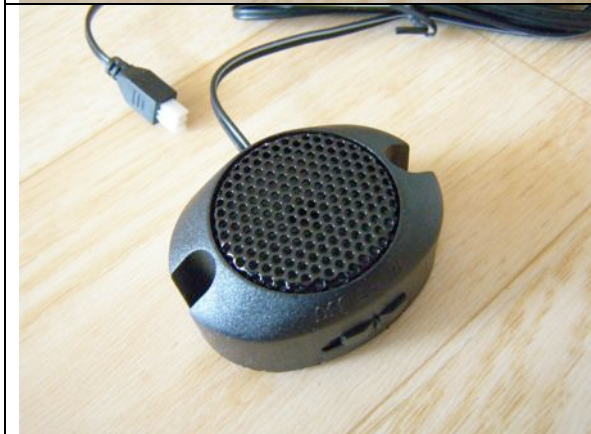
Akustisches Signalgerät. An der Seite ist der Schalter sichtbar, mit dem die Lautstärke geregelt werden kann.
