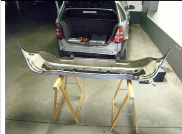
Demontierte Heckstoßstange auf den Werkstattböcken
