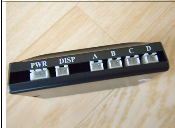
Steuergerät mit den Anschlüssen für Sensoren, Signalgerät und Strom
