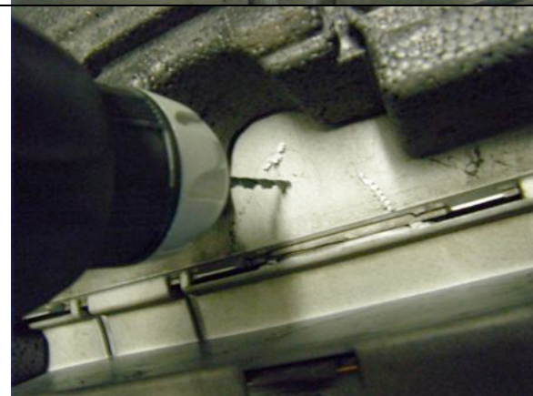
Führungsloch vorbohren mit 4mm-Bohrer
