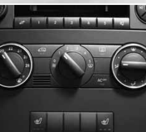
Klimaanlage und Umluftschalter ▲
